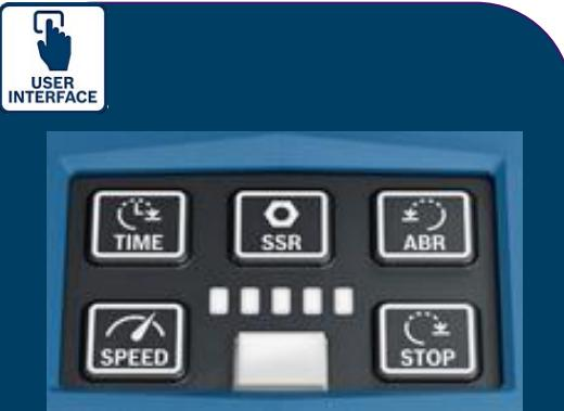
La función **ABR** (Automatic Bold Release) está diseñada para aflojar tornillos o tuercas métricas. Detiene la herramienta una vez que se ha aflojado la tuerca, evitando así que se caiga. Por lo tanto, este modo solo se activa cuando el atornillador de impacto está aflojando.
