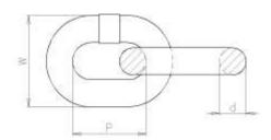
P: paso o longitud interior :  $\approx 27 \text{ mm}$ W : anchura exterior del eslabón :  $\approx 22 \text{ mm}$
