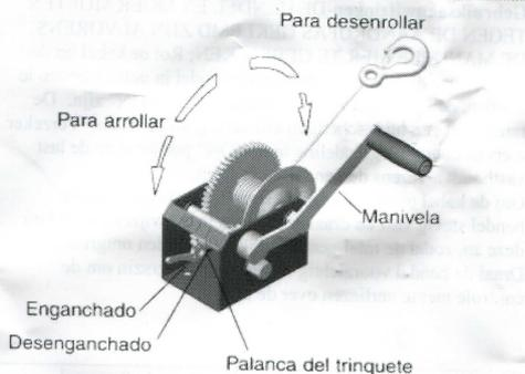
**MANTENIMIENTO DEL CABRESTANTE** — Este cabrestante ha sido completamente lubricado en la fábrica. Para continuar obteniendo un rendimiento uniforme y alargar su vida útil, se recomienda engrasar ocasionalmente los engranajes y el eje del carrete y aplicar una gota
