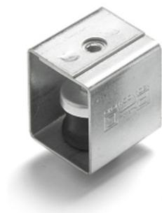
Gama diseñada para la suspensión de falsos techos acústicos y maquinaria trabajando a partir de 1.000 r.p.m. En toda la gama Akustik se mantiene el mismo elemento antivibratorio fabricado en caucho de gran calidad mecánica, especialmente diseñado para el aislamiento vibratorio. La estructura metálica es resistente a más de 650 kg y recubierta de baño electrolítico bicromatado.
