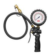
Verificador de presión inflado manual. Permite el control del llenado y el vaciado de la presión de aire en el neumático. Incluye: manómetro indicador de la presión, graduado de 0 a 12 bar, con protector antigolpes, empuñadura ergonómica, flexible de 650 mm y boquilla autosujetable.
